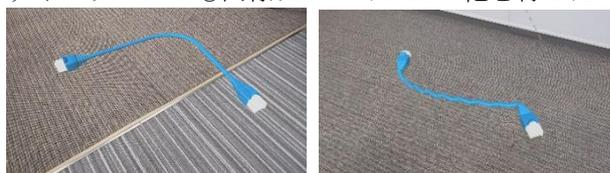
図 1 硬直 LAN ケーブル 図 2 フレキシブル LAN ケーブル
