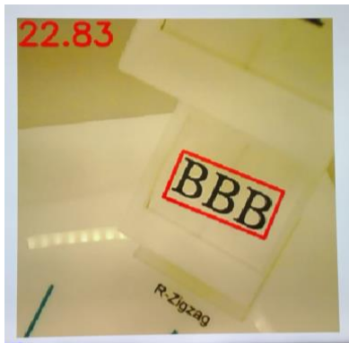
図2 文字列の認識と角度の表示 認識した文字列を赤色の枠で囲み、赤色の枠の水平方向に対する角度（時計回転方向を正）を左上に表示した。
