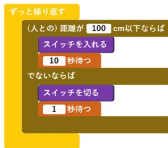
図1 通電を制御するプログラム例 (手引 p. 26 の図を引用)
