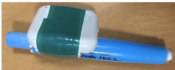
図1 加速度センサを取り付けたチョークホルダー
